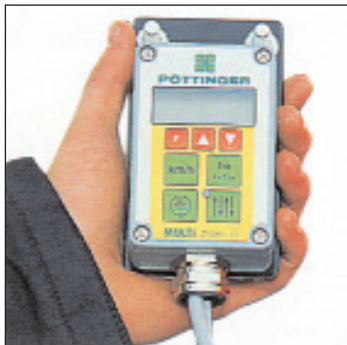
ELEKTRONICKÝ OVLÁDACÍ PANEL MULTITRONIC JE UMÍSTĚN V KABINĚ TRAKTORU
