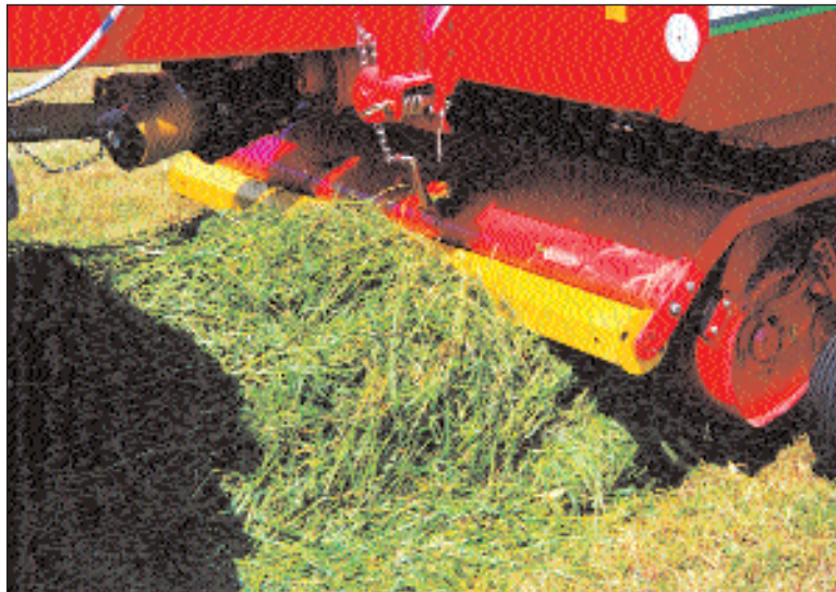
OBR. 1 POHLED NA ČINNOST SBĚRACÍHO ÚSTROJÍ SAMOSBĚRACÍCH VOZŮ JUMBO FIRMY PÖTTINGER
