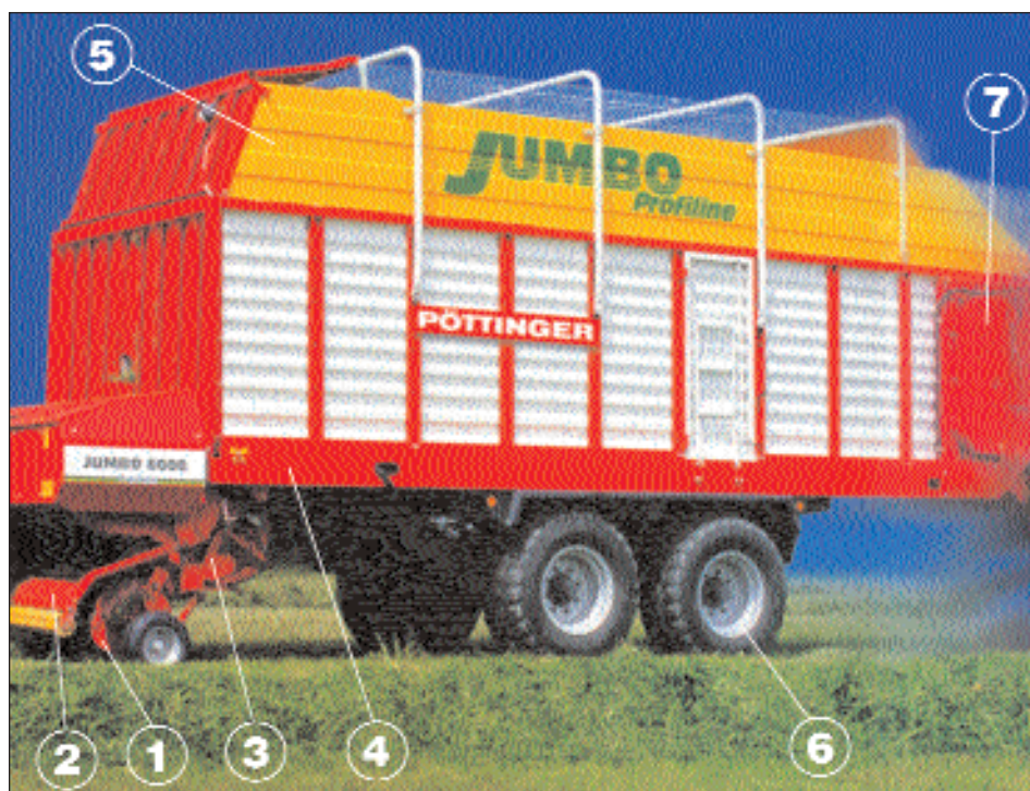
1) SBĚRACÍ ÚSTROJÍ MÁ ŠEST ŘAD OBOUSTRANNĚ VEDENÝCH SBĚRACÍCH PRSTŮ. 2) PŘÍTLAČNÝ PLECH S VKLÁDACÍM KOLEČKEM. 3) SEZACÍ ÚSTROJÍ UMOŽŇUJE DOSÁHNOUT DÉLKY ŘEZANKY VHODNĚ PRO SENÁŽOVÁNÍ. 4) RÁM STROJE JE ROBUSTNÍ. ZÁKLADNÍM SPOJOVACÍM PRVKEM JSOU ŠROUBOVÉ SPOJE. 5) LOŽNÝ PROSTOR MÁ OBJEM 60 AŽ 72 M 3 PODLE TYPU SAMOSBĚRACÍHO VOZU. 6) TANDEMOVÁ NÁPRAVA MŮŽE BÝT NA PŘÁNÍ VYBAVENA ODPRUŽENÍM VZDUCHOVÝMI MĚCHY. 7) K VYKLÁDÁNÍ JE MOŽNO POUŽÍT VYPRAZDŇOVACÍ VÁLEČEK NEBO ZADNÍ OTEVÍRATELNOU STĚNU
