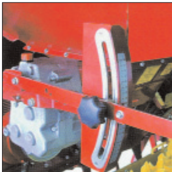
VELIKOST VÝSEVKU SE MĚNÍ POMOCÍ PŘEVODOVKY S PLYNULÝM PŘEVODEM
